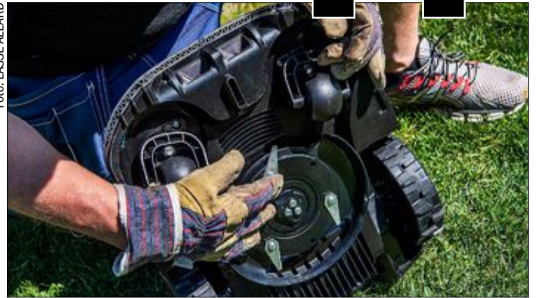
Lösa knivar, eller "rakblad", är lätta att byta när de slitits ned. Men om de går emot något hårt kan du få vassa metallbitar i gräsmattan.
